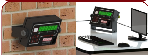
Os Indicadores Digi-tron podem ser instalados em paredes, mesas ou em colunas.
